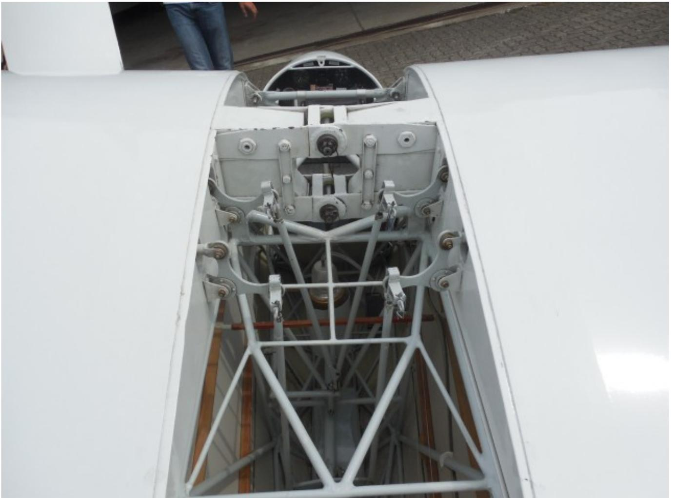
— Blick in den Stahlrohrumpf auf das Rudergestänge.
